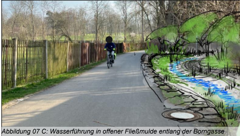
Abbildung 07 C: Wasserführung in offener Fließmulde entlang der Borgasse
