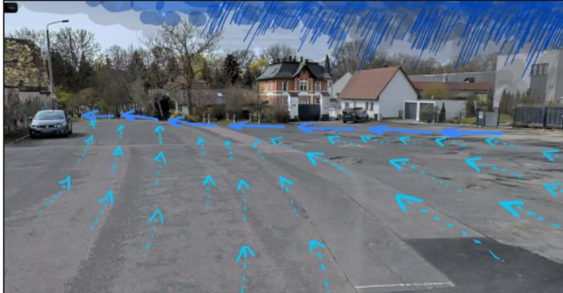
Abbildung 07 A: Modellierung der Geländeoberfläche zur Abflusslenkung
