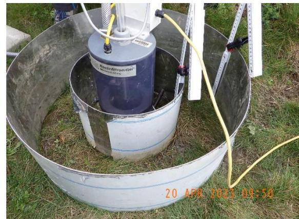
Abb. 3-1: Doppelringinfiltrometer
