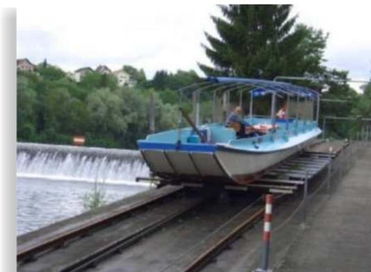
Abbildung 11 Weidling (Flachboot) auf dem Rollberg am Kraftwerk Rheinau in der Schweiz
